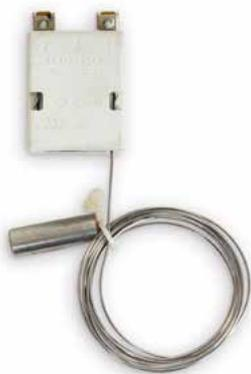
Le limiteur de température maximale KRU est un capteur à tube capillaire mécanique qui permet de limiter les températures au sol pour le chauffage à accumulation et d'appoint, ou également sous les sols stratifiés. Le KRU convient parfaitement pour une installation dans un boîtier encastrable 100 | 100.
