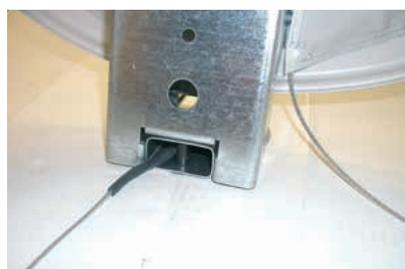
Câble de chauffage pour le chauffage du bras du récepteur
