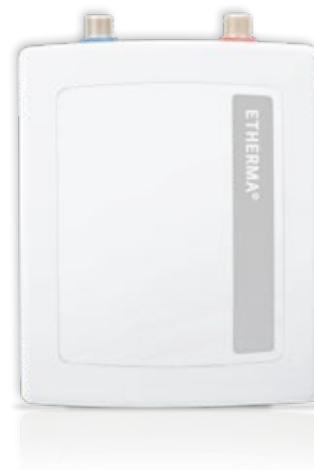
Le chauffe-eau instantané à commande hydraulique ETHERMA AQUA WHM en version résistante à la pression convient au chauffage rapide de l'eau chaude en cas de volume d'eau limité des lavabos. L'interrupteur de pression différentiel intégré permet un démarrage à partir de 1,2 bars et un débit d'eau à partir de 1,2 l/min. Il met automatiquement l'appareil en mode chauffage.
