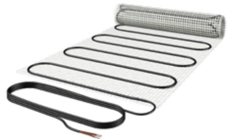
Die Freiflächenheizung GSN zum Einbau in Gussasphalt dient der Schnee- und Eisfreihaltung von Parkgaragen-Einfahrtsrampen, Rettungszufahrten, Eingangsbereichen, etc. Die Heizmatte GSN besteht aus einem Glasseiden-Panzergeflecht auf dem ein Dipolheizleiter befestigt ist. Die erlaubte Aufbringungstemperatur beträgt 240 °C für 35 min.
