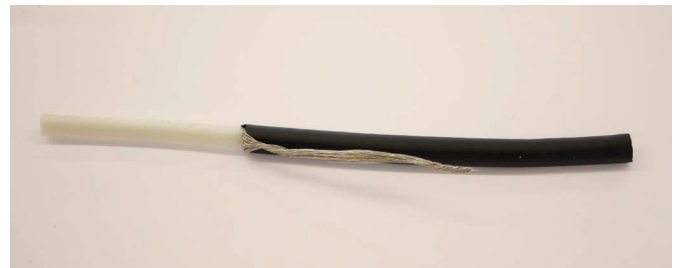
2. Schutzgeflecht bzw. den Aluschirm auftrennen. Schutzgeflecht zusammendrehen und zurückbiegen bzw. Aluschirm entfernen und Erdung zurückbiegen.
