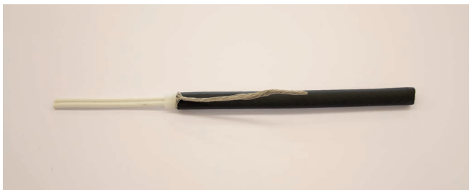
3. Innenisolierung mittels Messer ca. 70 mm abisolieren und entfernen.
