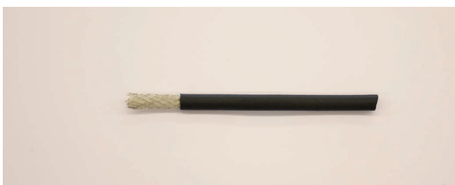
1. Außenmantel mit einem Messer ca. 50 mm abisolieren.
