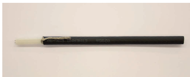
2. Schutzgeflecht bzw. den Aluschirm auftrennen. Schutzgeflecht zusammendrehen und zurückbiegen bzw. Aluschirm entfernen und Erdung zurückbiegen.
