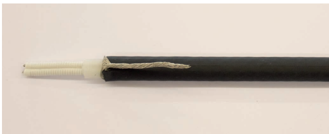
3. Innenisolierung mittels Messer ca. 40 mm abisolieren und entfernen. Heizdraht bis zur Innenisolierung entfernen.
