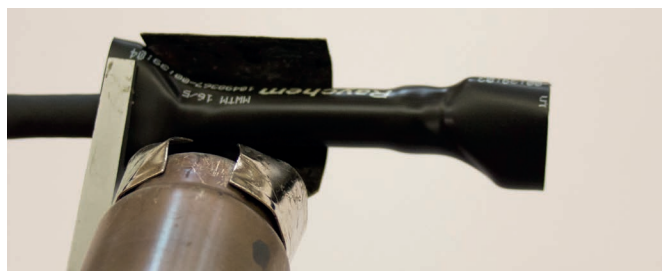
6. Außenschumpfschlauch mit Heißluftföhn von Innen nach Außen aufföhnen. Danach mit Flachzange ca. 10 Sek. zusammendrücken.
