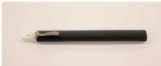
4. Innenisolierung in der Mitte auftrennen - eine Litze ca. 1 cm kürzen.
