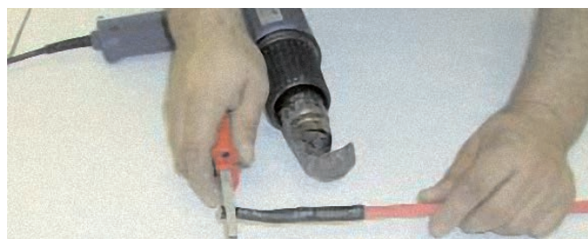
5. Föhnen Sie den Außenschrumpfschlauch mittels Heißluftföhn auf und drücken Sie das Ende des Schrumpfschlauchs mittels einer Flachzange für ca. 10 Sekunden zusammen.
