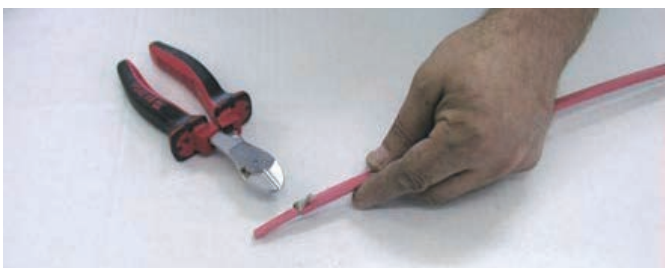
3. Zwickeln Sie das Schutzgeflecht bzw. die Erdung mittels Seitenschneider auf ca. 10 mm ab und schieben Sie es zurück.
