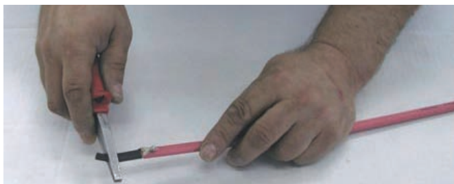
4. Föhnen Sie den Schrumpfschlauch 9/3 40 mm mittels Heißluftföhn auf und drücken Sie das Ende des Schrumpfschlauchs mittels einer Flachzange für ca. 10 Sekunden zusammen.
