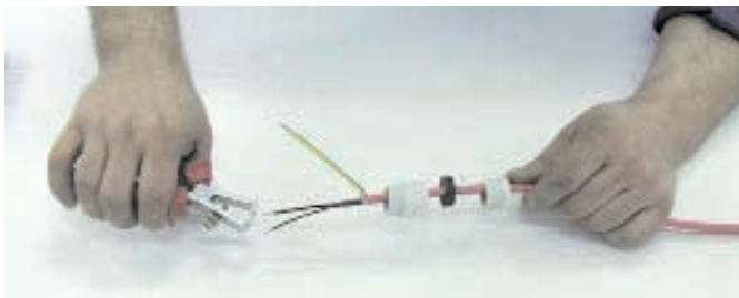
7. Isolieren Sie die Litzen mittels Abisolierzange ca. 10 mm ab.
