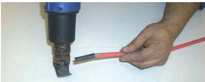
4. Föhnen Sie den Schrumpfschlauch 9/3 40 mm mittels Heißluftföhn auf und drücken Sie das Ende des Schrumpfschlauchs mittels einer Flachzange für ca. 10 Sekunden zusammen.
