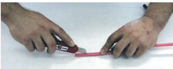
1. Isolieren Sie den Außenmantel mit einem Messer ca. 40 mm ab.
