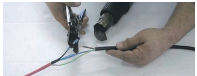
6. Isolieren Sie die Litzen versetzt mittels Abisolierzange ab und verpressen Sie diese mit der Anschlussleitung.
