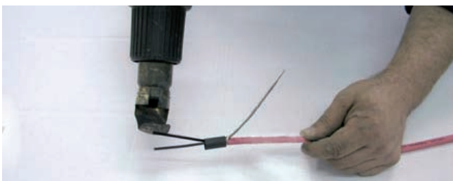
5. Föhnen Sie den Schrumpfschlauch 9/3 20 mm mittels Heißluftföhn auf.
